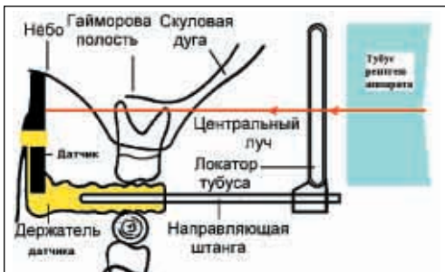
Рис.7. Параллельная техника. Приемник изображения устанавливается с помощью позиционера.
